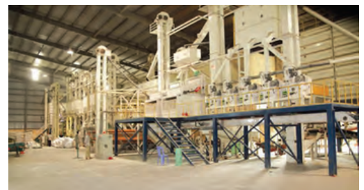
Dây chuyền chế biến gạo (xay xát – đánh bóng – tách màu)
